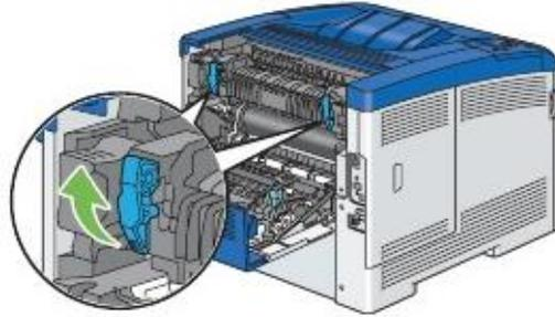
STEP 8：抓住凸出的部分並往外拉開啟內部零件。
